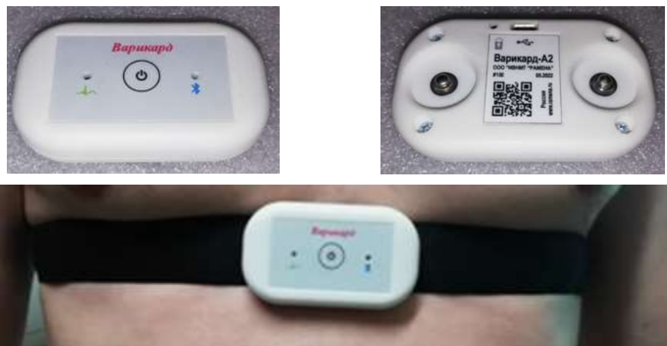
Рис. 10. Внешний вид кардиоусилителя Варикард А2 (вид сверху – слева, вид снизу – справа). Внизу приведена схема крепления кардиоусилителя на теле пациента.
